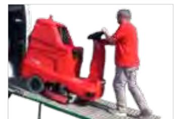
Sistema de conducción a distancia que facilita la carga y descarga de la máquina
