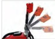
Puesto de conducción regulable en altura y ergonómico
